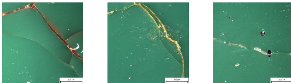
Obr. 6 Přítomnost barev v povrchových prasklinách kostek po aplikaci prostředku GR. Měřítko 200 \mu\text{m} .
